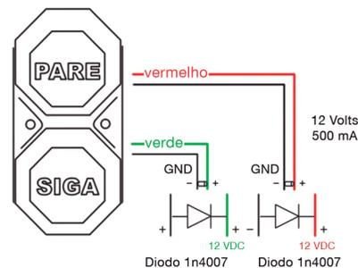
Ao instalar o semáforo, certifique-se de que instalou o diodo corretamente.
